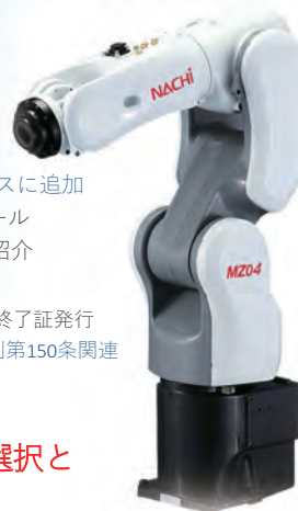
体験ロボット 《不二越》 垂直多関節ロボット MZ04
